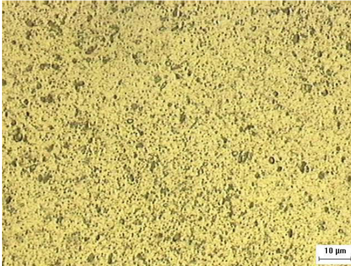
Figura N° 9.- Microestructura del tubo fracturado, constituida por una matriz de aluminio con fases dispersas, vista a 500X.
